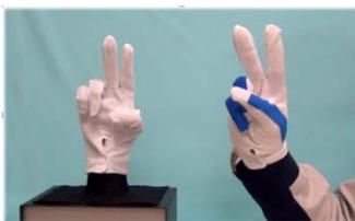
ロボットハンド操作用センサグローブ
