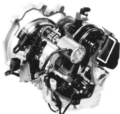
(a) 複合Vベルトを用いた乾式 CVT
