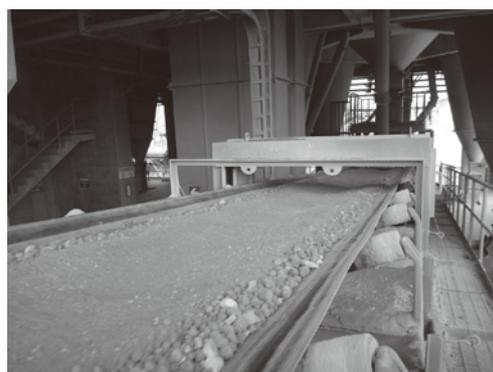
図1. 製鉄所の焼結鉱、焼結原料、コークス搬送ライン、セメント工場の乾燥石灰石、乾燥粘土搬送ラインなど、常温より高く、火災時の延焼抑制効果が要求される用途に適用します。
