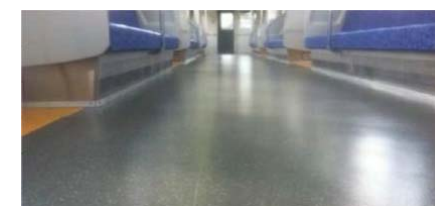
↑ 鉄道車両用難燃性ゴム床材 「バンドーバンライト®EZ-stick®」
