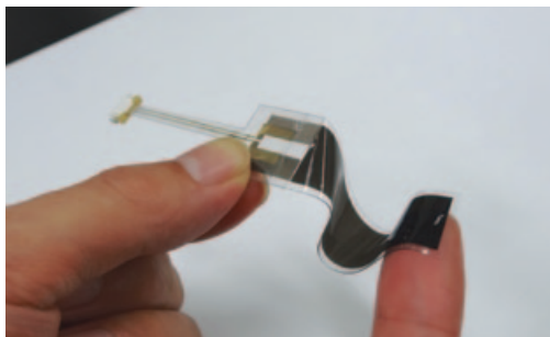
伸縮性ひずみセンサ「C-STRETCH®（シーストレッチ）」
