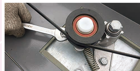
HFD®システムの交換(スパナ1本で容易にベルト交換が可能)
