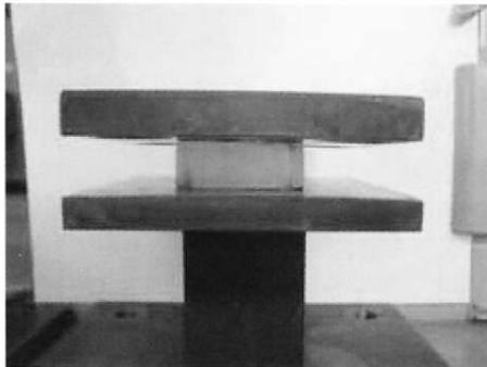
図2 ポリウレタンゴム試験体 (20mm)
