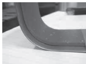
図6 感温接着性の確認試験
