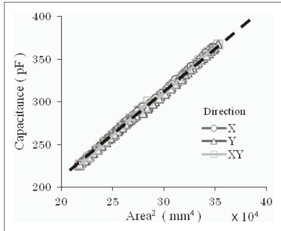
図2 検知部面積と静電容量の関係
