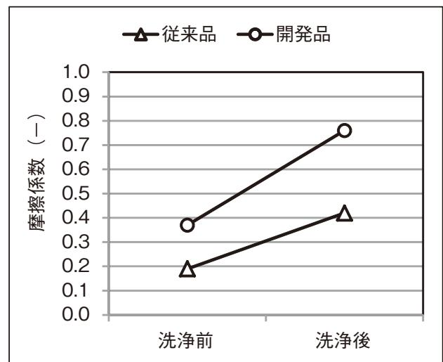
図5. 洗浄前後のベルト背面摩擦係数
