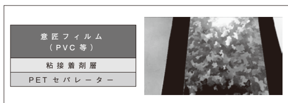
図4. 加飾フィルムの断面構成(左)と精密柄エンボスPVCフィルム(右)
