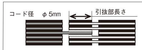
図 9. 台上試験用試験片
