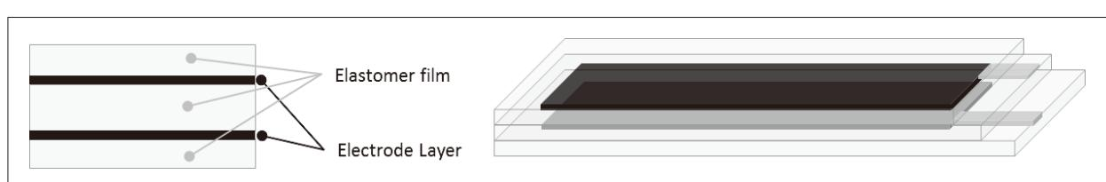
図1. 構造の模式図（左：断面図、右：斜視図）
