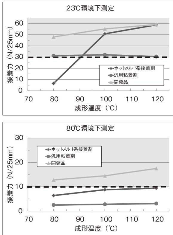
図9. 開発品における加飾成形時の成形温度と接着力との関係 (23°Cおよび80°C環境下での接着力測定)
