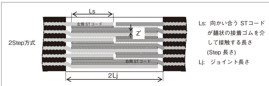
図2. ジョイント構造の一例 (2Step方式)
