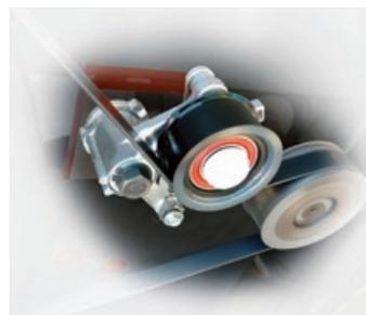
「平ベルト駆動システム（Hyper Flat Drive System:HFDシステム）」
