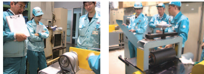
危険体感機を使った教育 (写真左) Vベルト・チェーン巻き込まれ体感 (写真右) ロール・シート巻き込まれ体感
