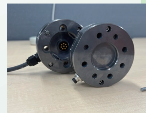
エアレス構造により、着脱時の動力源が不要
